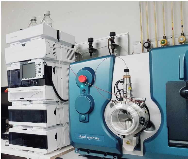
Bildnachweis: Dr. F. Lessmann (HPLC-MS/MS System (Agilent/SCIEX QTRAP 5500) zur Bestimmung spezifischer DEHTP-Biomarker)
