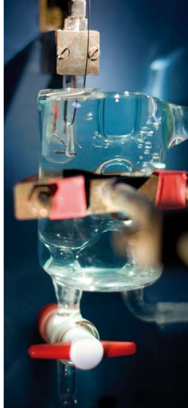
Revolutionäre Forschung am UKE: Beim EHT-Versuch (Engineered Heart Tissue) von Prof. Dr. Wolfram-Hubertus Zimmermann und Prof. Dr. Thomas Eschenhagen am Institut für Experimentelle und Klinische Pharmakologie wird die Kontraktionsleistung von zirkulären, runden Herzmuskel-Fibrinellen neonataler Ratten in der Versuchsanordnung getestet.
